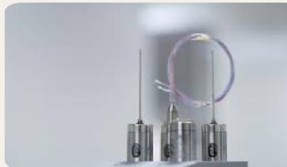
No processo de validação a empresa contratada para realização do serviço deve utilizar termopares para obtenção dos dados paramétricos do ciclo (leitura de tempo, temperatura e pressão).
