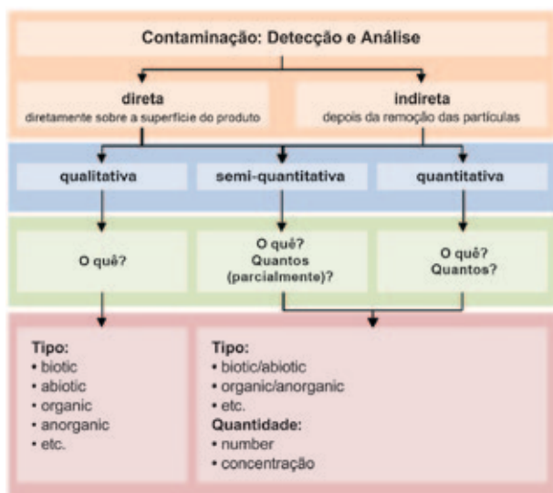
Figura 3. Abordagens para detectar a contaminação em superfícies de validação quantitativa do estado de limpeza
