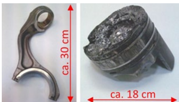
Figura 5. Haste de conexão danificada (à esquerda) e cilindro (à direita). Razão de falha foi uma injeção contínua de gás causada por uma partícula de tamanho micrométrico.
