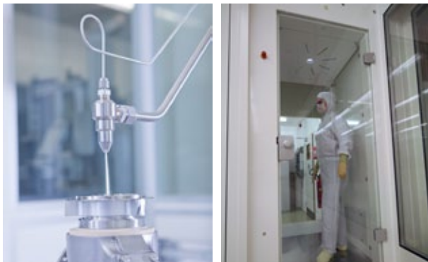
Figura 4. Limpeza com Neve de CO 2 como tecnologia de limpeza ultra precisa (à esquerda) usada na Sala Limpa no ESTEC (à direita).
